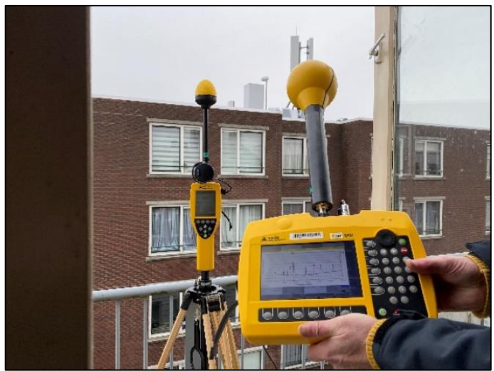
Figuur 2: Foto van de breedbandige en selectieve outdoor meetopstelling op het balkon
