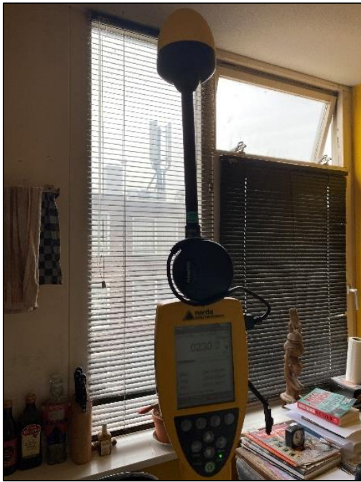
Figuur 1: Foto van de breedbandige indoor meetopstelling in de keuken
