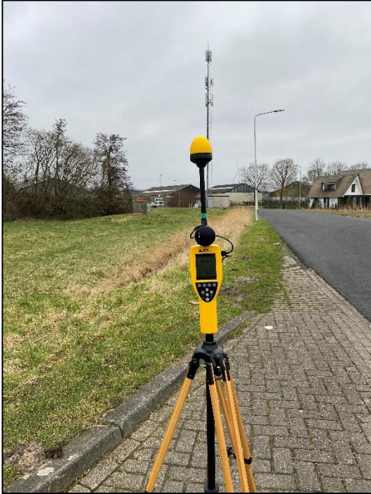
Figuur 1: Foto van de breedbandige outdoor meetopstelling
