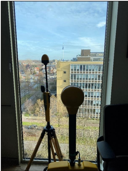
Figuur 1: Foto van de breedbandige indoor meetopstelling in de studeerkamer
