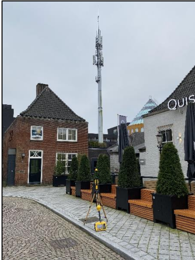
Figuur 1: Foto van de breedbandige outdoor meetopstelling
