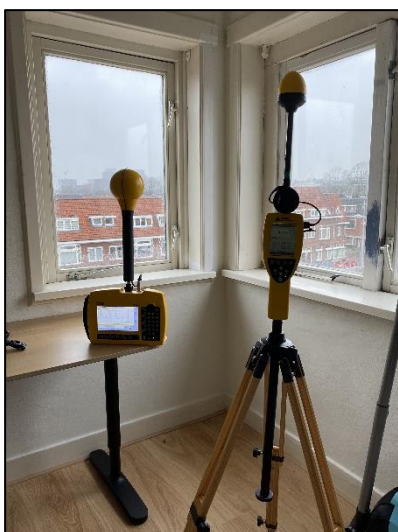
Figuur 2: Foto van de breedbandige indoor meetopstelling in de slaapkamer
