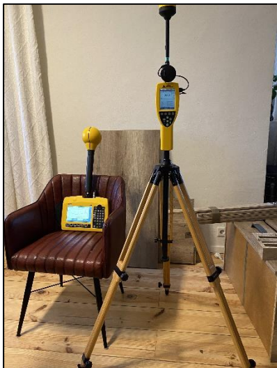
Figuur 1: Foto van de breedbandige indoor meetopstelling in de woonkamer
