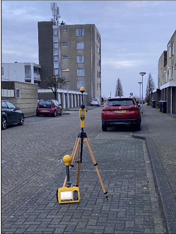
Figuur 1: Foto van de breedbandige outdoor meetopstelling
